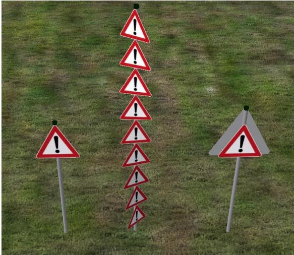
Die Schildplätze stehen 90° zu einander gedreht. Um andere Winkel zu erreichen muss das Pfostenstück, an dem das Schild befestigt wird, um den entsprechenden Winkel gedreht werden. Gegenüberliegende Schildplätze (10 und 12 bzw. 11 und 13) können gleichzeitig belegt werden, sodass der Mast von beiden Seiten beschildert ist.
